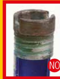
*Un calentamiento (segmento ennegrecido) causa una disminución del poder de corte. Es necesario afilar la herramienta.*
